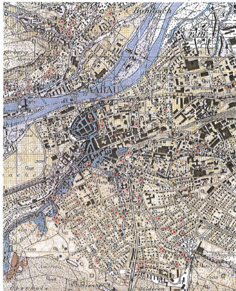
Die roten Punkte markieren die Erdsonden in Aarau. Die übrigen Punkte sind andere Bohrungen zur Gesteinsschicht der jeweiligen Farbe. Die Flächenfarben markieren die oberste Schicht: Blau Kalk, orange Molasse (unten links), gelb Hanglehme, grün und grau Schotter.
